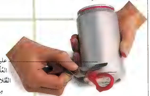
عليك أن تُزيل طلاء العلبة، وإلا سيوقف الطلاء الكهرباء ويمنعها من الوصول إلى المغنطيس الكهربائي.
